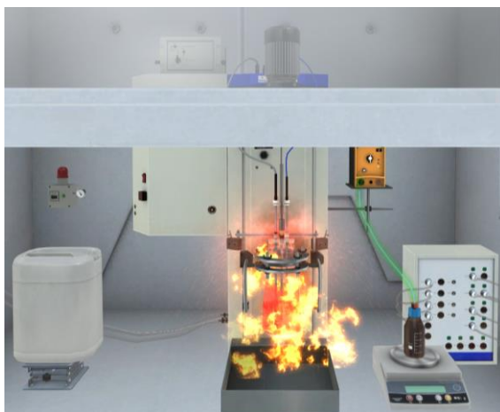
图 3 反应体系失控导致火灾事故
